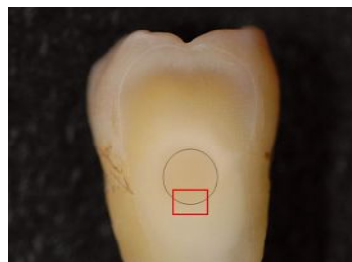
図4 コントラクションギャップ観察用の試片
