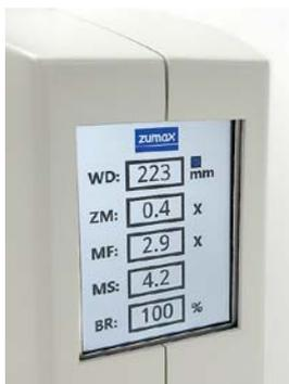
第2アーム先端に配置された液晶ディスプレイには、マイクロスコープの設定状況をリアルタイムに表示。
